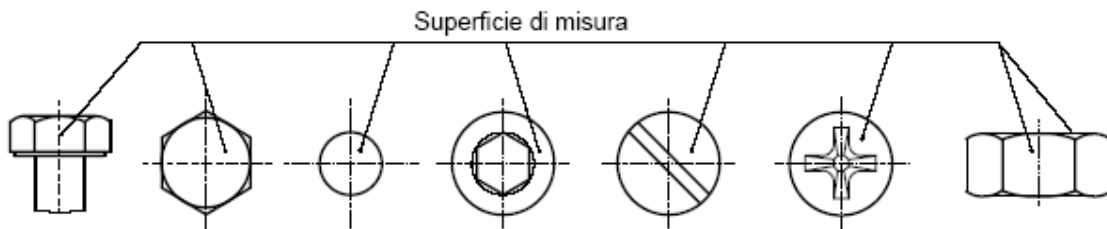
Fig. 1 - Superficie di misura per lo spessore locale ( superficie significativa)
